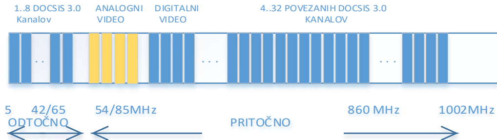
Slika 12: Razdelitev frekvenčnega spektra v kablskem omrežju DOCSIS 3.0
